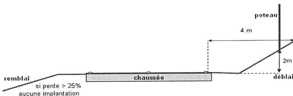
Si les contraintes de terrain ne permettent pas de répondre à ces préconisations, le demandeur peut prévoir dans son projet de placer à sa charge des glissières de sécurité afin d'isoler son ouvrage de la circulation routière. Etant précisé que pour limiter les contraintes d'entretien sous glissière, cela conduit également pour le demandeur de procéder au revêtement de l'accotement.
